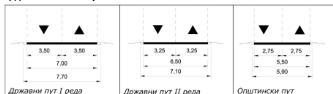
Слика 1: Попречни профили јавних путева
