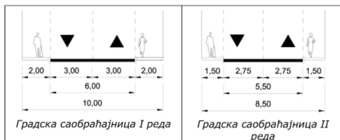
Слика 2: Попречни профили градских саобраћајница I и II реда
