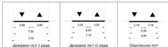
Слика 1. Попречни профили јавних путева
