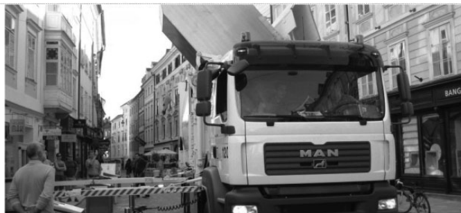
Слике бр. 6-9: Примери специјализованих возила за прикупљање и транспорт отпада из подземних контејнера
