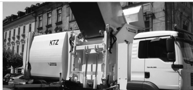
Слике бр. 6-9: Примери специјализованих возила за прикупљање и транспорт отпада из подземних контејнера
