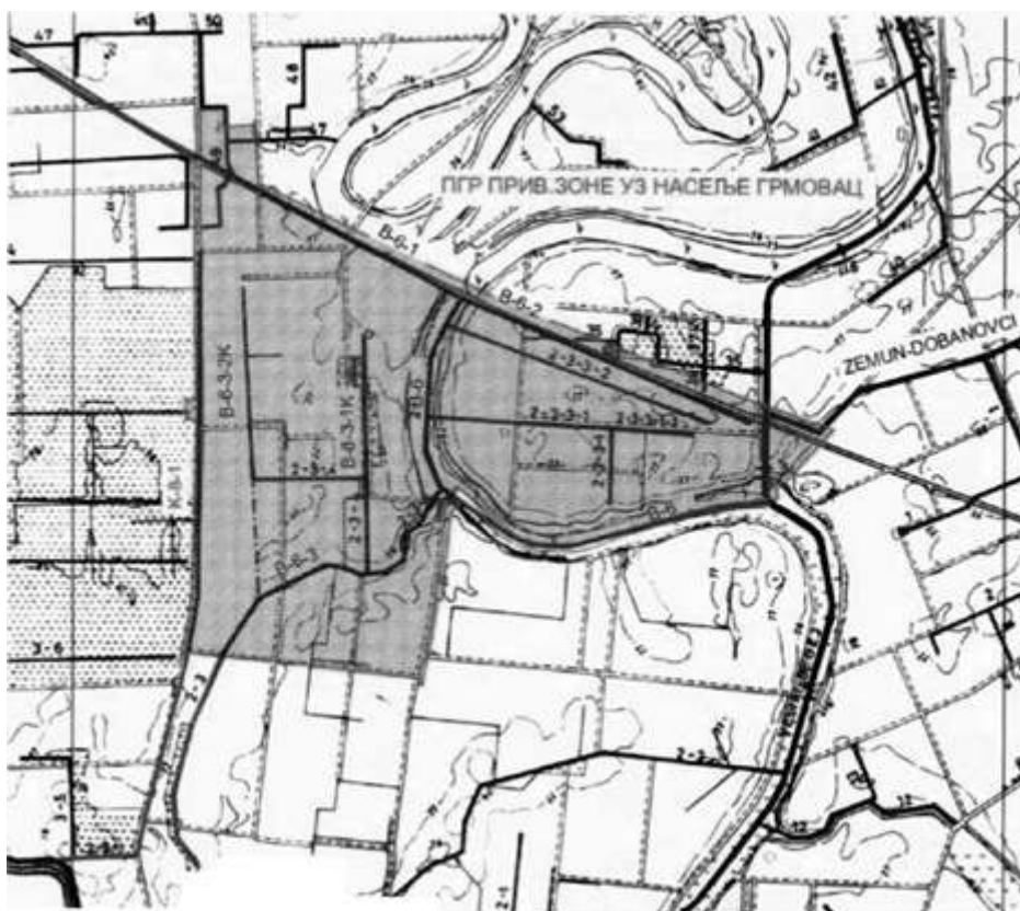
Скица 1. – Мрежа мелиорационих канала (канал 2-3-3-1, 2-3-3-1-2, 2-3-3-2, 2-3-4 и 2-3-4-1 су затрпани).
